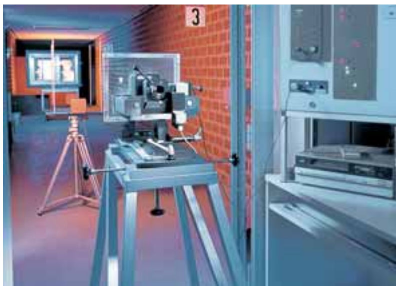
Beschuss-Prüfstand im Schüco Technologie-Zentrum Ballistics test rig in the Schüco Technology Centre
